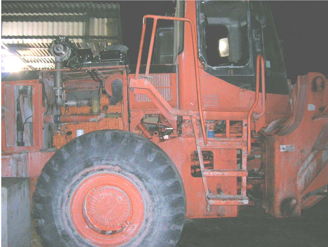
남해화학, 비료공장 Wheel loader, 2008년 4월 설치 -버너+ 촉매 필터 -자동 및 수동 재생
